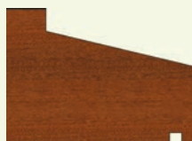
Voorbeeld van oorspronkelijke kozijndetail (doorsnede van een kozijndorpel)
