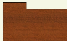
Gewijzigde kozijndetail waarbij de karakteristieke profilering wordt verwijderd. Dit is een voorbeeld van een wijziging van een kozijndetail die niet is toegestaan.
